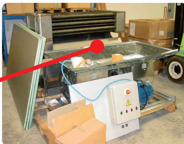
Nos appareils sont entièrement démontables (option). Dans cet exemple il s'agit d'un SES 300 démonté dans nos ateliers et remonté dans la chaufferie de l'Eglise Heilige Hart (Antwerpen).
